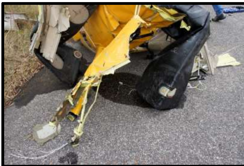
Fotografía No. 18. Vista de los tanques de combustible.
