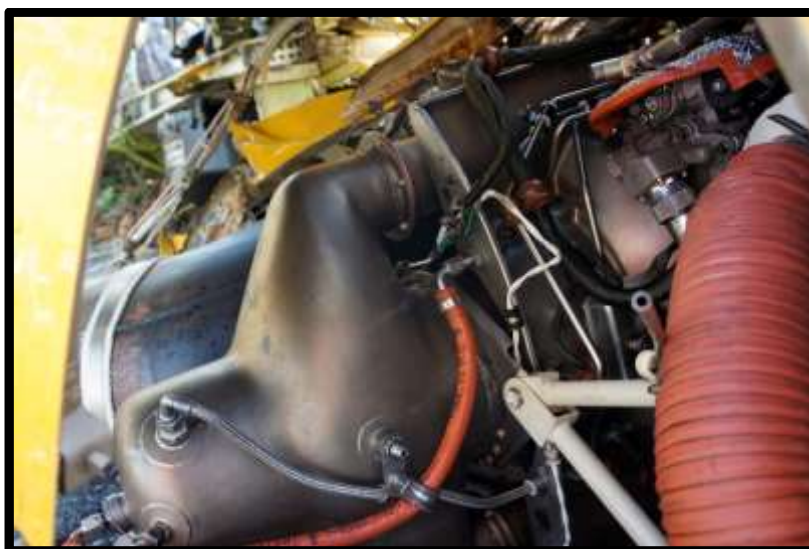
Fotografía No. 17. Vista de la cámara de combustión del motor.
