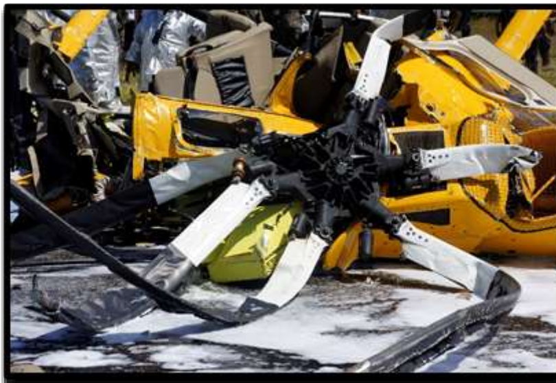
Fotografía No. 4. Vista de rotor principal y daño total a las palas.
